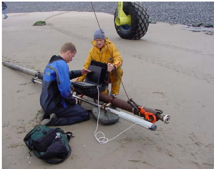
Figuur 7: Uitlezen en programmeren van de ASM-IV aan de voet van de Hondsbossche en Pettemerzeewering.
