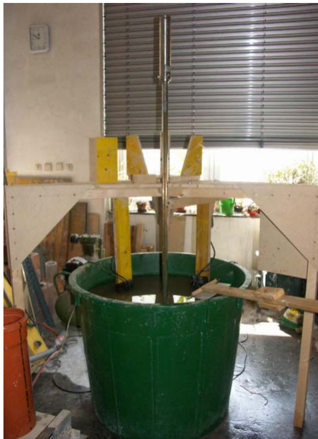
Abbildung 1: Versuchsanordnung zur Prüfung des ASM IV (Instrument in Bildmitte)
